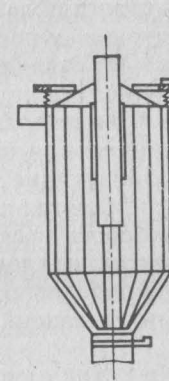
Рис. 4.30. Схема циклона с регенерацией внутренней полости с помощью вибрации
