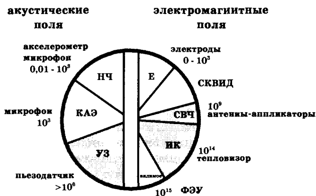
Рис. 12.1. Схема электромагнитных (справа) и акустических (слева) собственных полей человека. Электромагнитные поля: Е – электрическое поле, В – магнитное, СВЧ – сверхвысокочастотные электромагнитные волны дециметрового диапазона, ИК – электромагнитные волны инфракрасного диапазона, видимое – оптический диапазон излучений. Акустические поля: НЧ – низкочастотные колебания, КАЭ – кохлеарная акустическая эмиссия, УЗ – ультразвуковое излучение. Цифры – характерные частоты излучений (в герцах). Заштрихованы области тепловых излучений. Справа и слева указаны названия датчиков и приборов для регистрации соответствующих полей. СКВИД – сверхпроводящий квантовый интерферометр, ФЭУ – фотоэлектрический умножитель.
